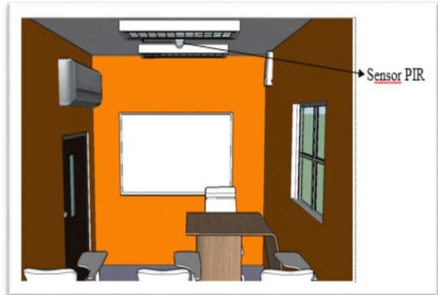
**Gambar 3.8.** Design tata letak sensor PIR pada Ruang Kelas
